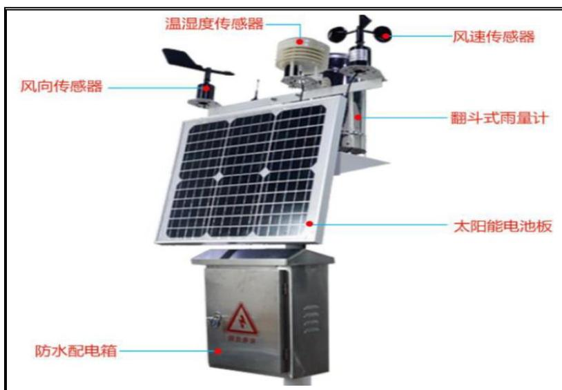
图 2.3-12 雨量计自动户外气象站示意图
